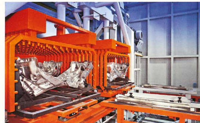
Durchlaufwärmebehandlungsanlage mit Luftabschreckung und bauteilspezifischen Spezialgestellen zur Minimierung der prinzipbedingten Bauteilverzüge
