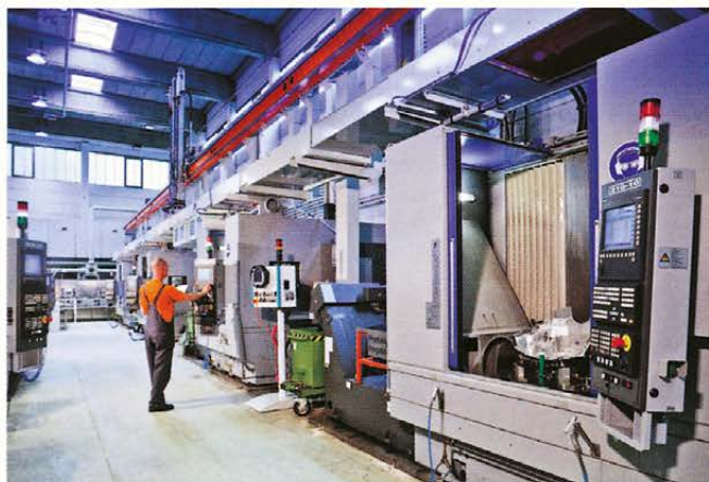
Eine der Finoba Bearbeitungslinien für Aluminium-Struktur- und Fahrwerksteile mit automatisierter Verkettung am Standort Baunatal
